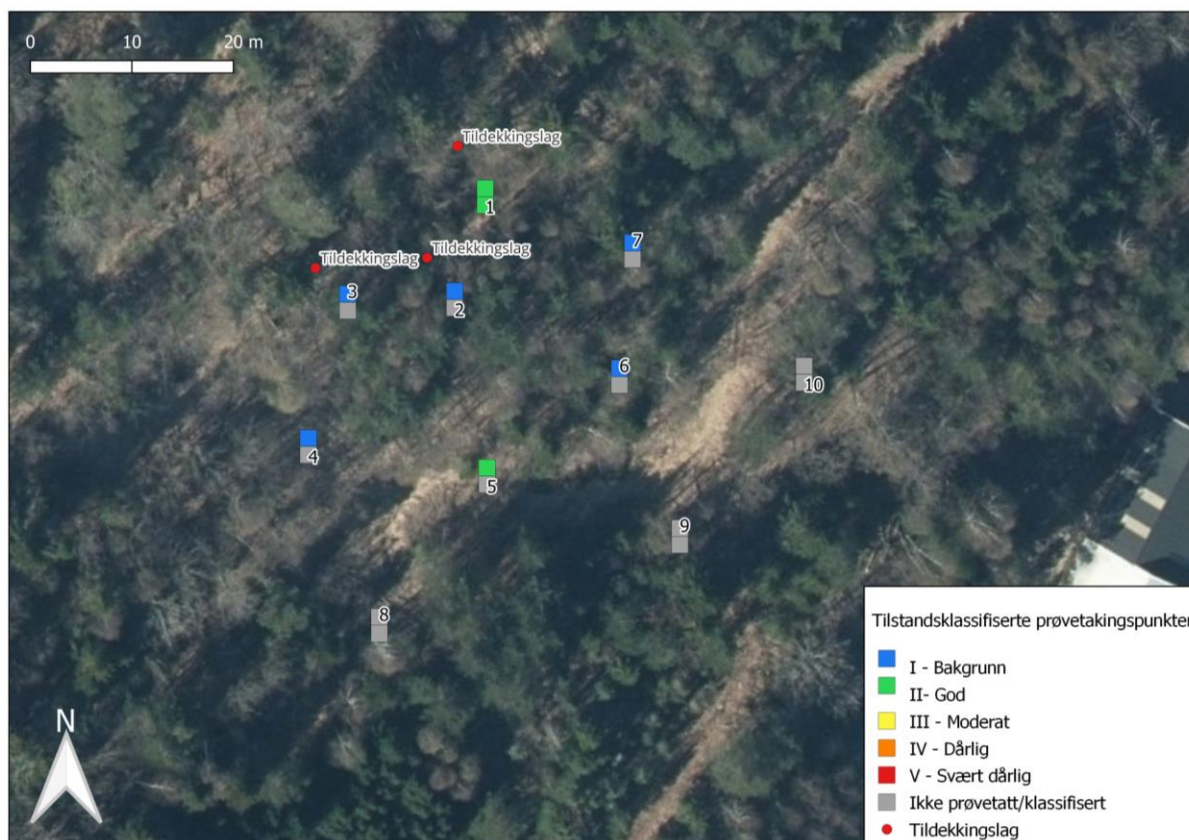
Figur 4. Høyeste påviste tilstandsklasse i prøvepunkt 1-7, etter TA-2553/2009. Øverste kvadrat symboliserer øvre 30 cm av toppjorden, og nederste kvadrat symboliserer jordlaget mellom 30-150 cm. Dypereliggende jord ble ikke prøvetatt ved punkt 2-7 (grå) på grunn av fjell i bakken. Punkt 8-10 (grå) ble prøvetatt, men er foreløpig ikke analysert. De registrerte punktkildene er benevnt tildekkingslag.
