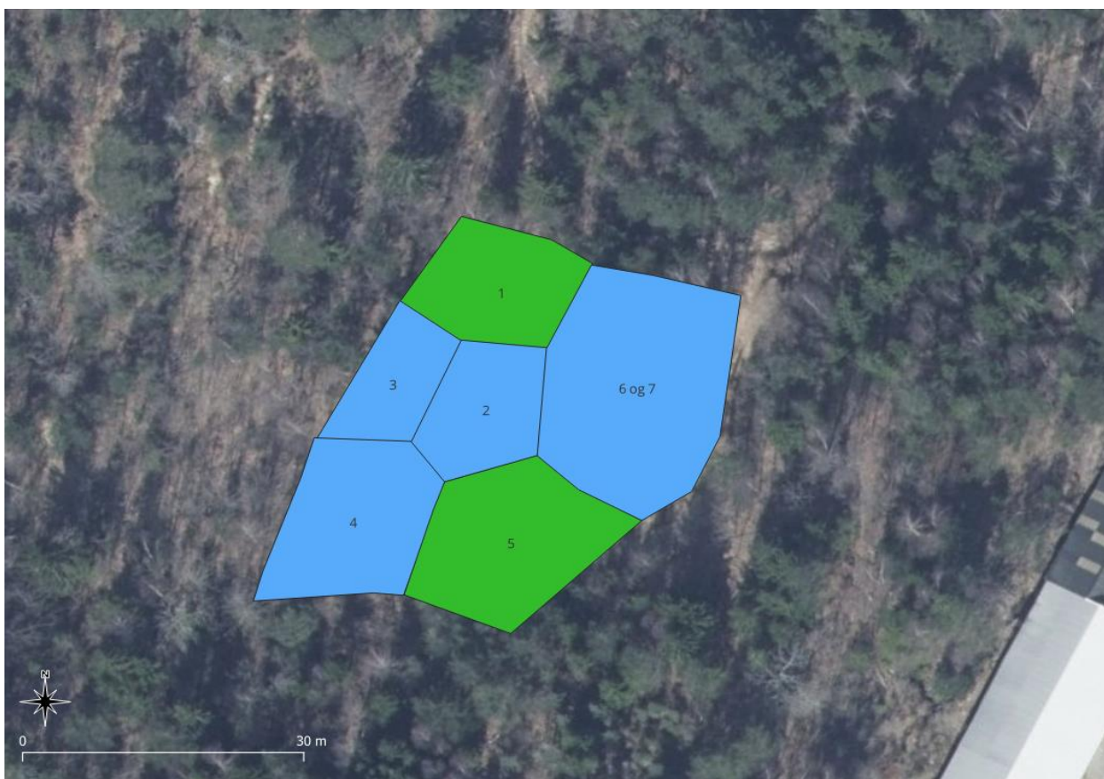
Figur 6: Masser tilknyttet tiltstandsklasse 1 (bakgrunn) = blå kan håndteres som rene masser, mens masser klassifisert tilstandsklasse 2 (god) = grønn må behandles som forurensede, og kan gjenbrukes på egen tomt eller leveres til godkjent deponi.
